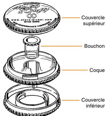
Pour remplir l'Accessoire de Remplissage, retirer le couvercle supérieur et remplir de matière végétale fragmentée la coque avec le bouchon. Remonter le couvercle supérieur et fermer.
