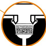
Chambre de Remplissage partiellement remplie avec Coussinet à Liquides superposé
