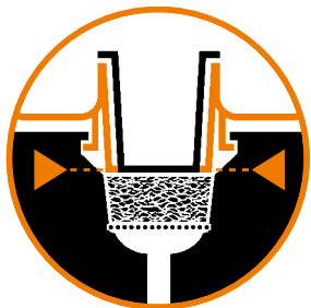
Le bord inférieur de l'Accessoire de Remplissage doit rester dégagé
